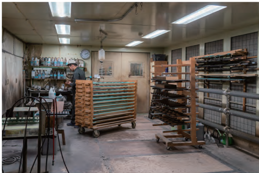
▲塗装設備も新木コーポレーションの強みの一つ。下塗りから仕上げまで全て自社で作業が可能。小さな埃やゴミの付着を防ぐクリーンルームも完備している。
